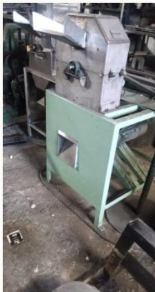
MAQUINA ABRIDORA DE FIBRA DE ARAMIDA PROVENIENTE DEL PROCESO DE MOLIDO DE RECICLAJE DE RESIDUOS DE TELAS IGNIFUGAS DE ARAMIDA.
