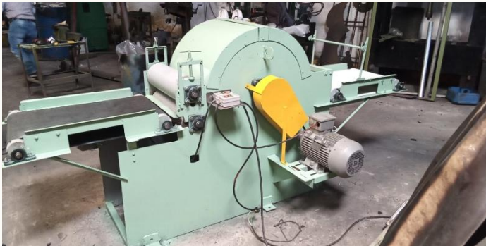
MAQUINA ABRIDORA DE FIBRA DE ARAMIDA PROVENIENTE DEL PROCESO DE MOLIDO DE RECICLAJE DE RESIDUOS DE TELAS IGNIFUGAS DE ARAMIDA.
