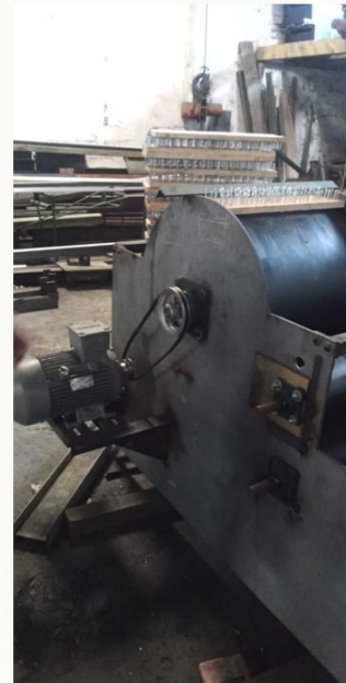
MAQUINA ABRIDORA DE FIBRA DE ARAMIDA PROVENIENTE DEL PROCESO DE MOLIDO DE RECICLAJE DE RESIDUOS DE TELAS IGNIFUGAS DE ARAMIDA.
